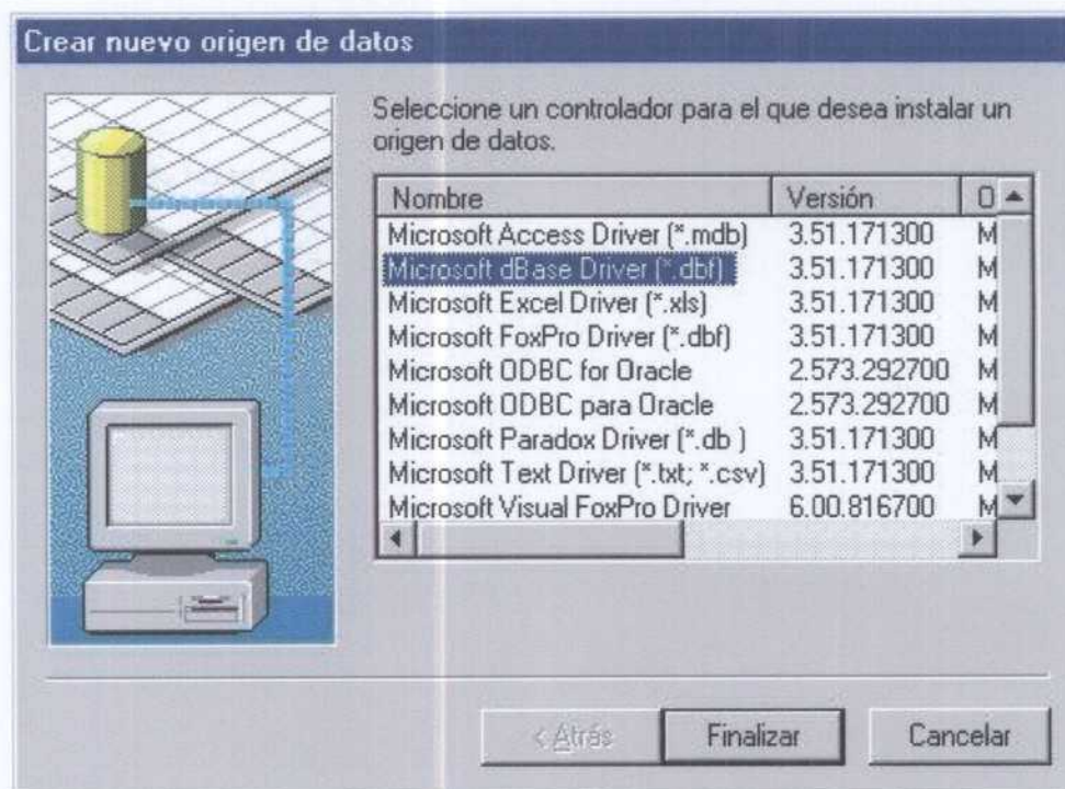
Figura 18. Ventana donde se agregan las conexiones a bases de datos. Selección de la conexión a bases de datos dBase.
